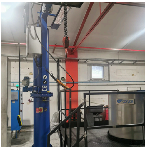
Komplet wanna hartownicza z olejem 1500l i żurawiem 1 tona bez UDT do obsługi pieca WH1500
