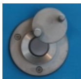
Глазок, устанавливаемый на двери печи, диаметром 20 мм
