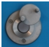
Глазок, устанавливаемый на двери печи, диаметром 20 мм
